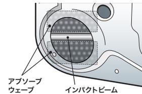
ドアにインパクトビームがある場合は、インパクトビームに吸音材を巻き付けるように施工してください。窓ガラスなどに干渉する場合は、上図のように切り離して貼り付けてください。
